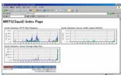
図8：Proxy サーバの通信量監視例 (MRTG)
